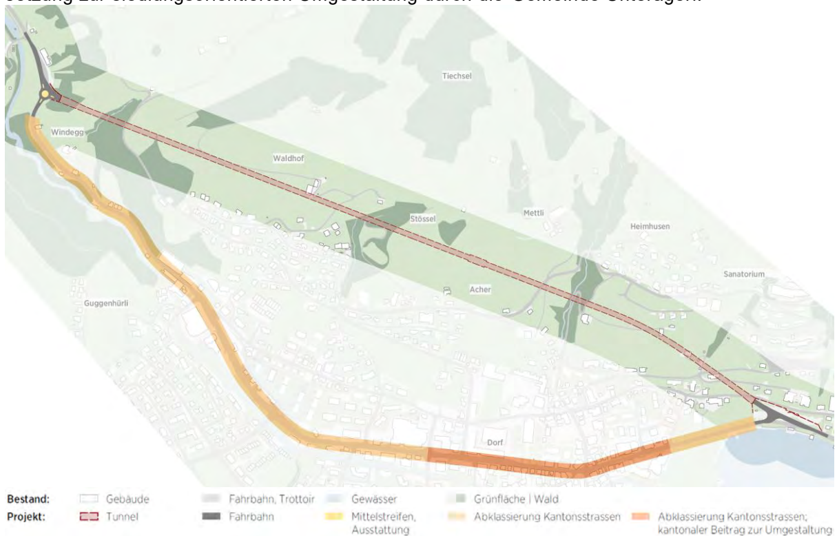
Abbildung 12: Situation Tunnel Umfahrung Unterägeri mit Abklassierung Zugerstrasse
