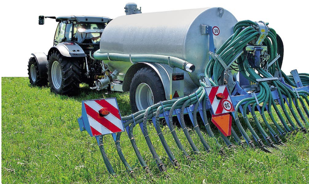
Die Ausbringung der Gülle mit Schleppschlauchtechnik gilt als die zurzeit wirkungsvollste Massnahme.
